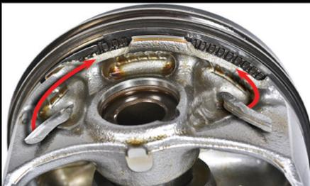
Un exemple d'endommagement des pistons dû à un événement de préallumage à faible vitesse a été observé lors du test de l'huile à moteur d'un concurrent. Les **flèches rouges** indiquent les sections des segments qui se sont détachées du piston.
