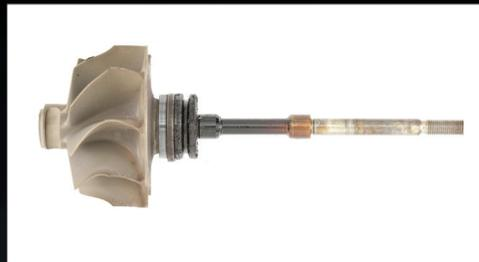
Les huiles de la série Signature ont contrôlé la chaleur et réduit les dépôts qui réduisent la performance sur les surfaces de l'arbre et du palier du turbo.
